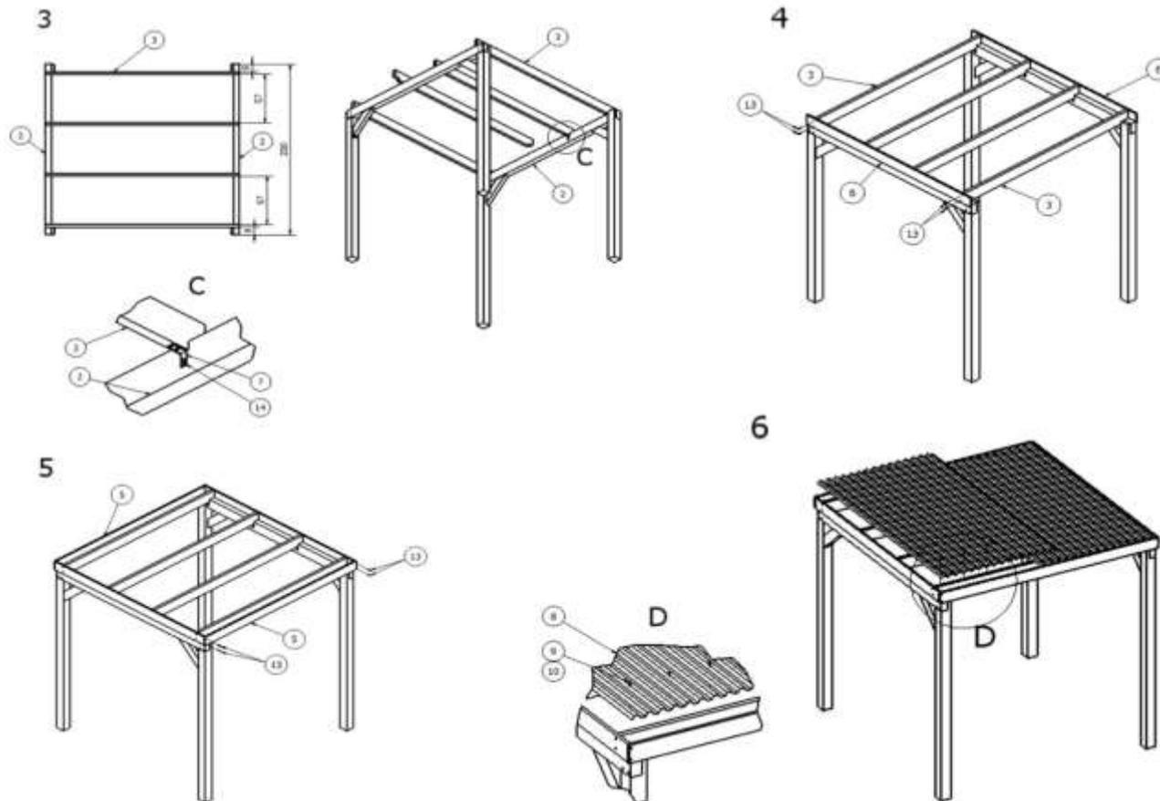
Si vous souhaitez une étanchéité parfaite entre les tôles, vous pouvez appliquer un joint silicone sur l'ondulation de la tôle qui se croise (joint non fourni).
